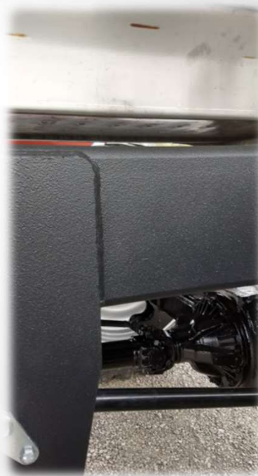
Protección de partes expuestas a maltrato mecánico.
