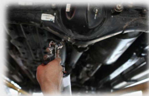
Protección de partes expuestas a maltrato mecánico.
