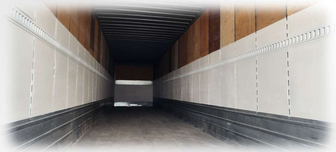
Protección en paredes de triplay
